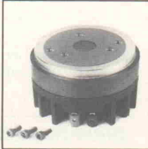
DR 45: Hochwertiger, robuster und klangneutraler 1"-Treiber für Studio, PA und Disco, 70/100 Watt (12 dB/Okt. ab mind. 800 Hz), 8 Ω, 800-20000 Hz, 104 dB (in Verbindung mit Horn MHH 16.22)
