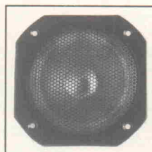
FRS 10 WP: (See-)Wasserfester und extrem hitzebeständiger Universal-Breitbandlautsprecher mit sehr guter Tonqualität für Schwimmbäder, Saunen, Boote, Autos und Motorräder, 10/25 Watt, 4 + 8 Ω, 80-16000 Hz, 89 dB
